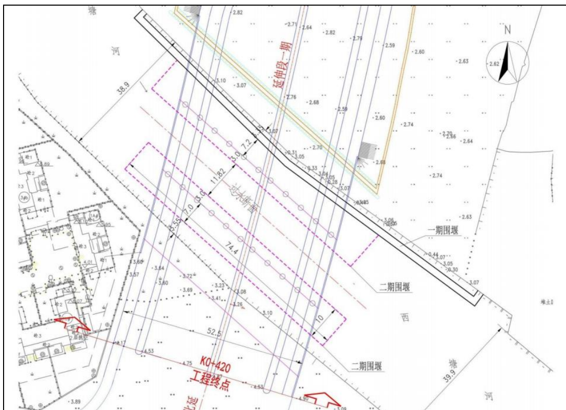
图 2-8a 西塘河路桥施工围堰平面布置图
